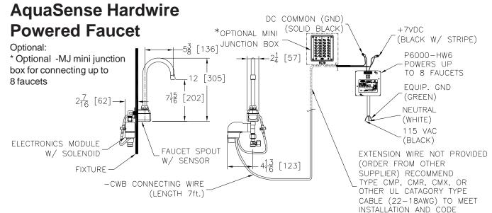
NOTE: MUST USE EITHER ZURN P6000-HW6 HARDWIRE POWER CONVERTER OR ZURN P6000-PC6 PLUG-IN POWER CONVERTER TO ENSURE PROPER OPERATION. USING A POWER CONVERTER OTHER THAN ZURN MAY RESULT IN OPERATION MALFUNCTION OR UNIT FAILURE.
